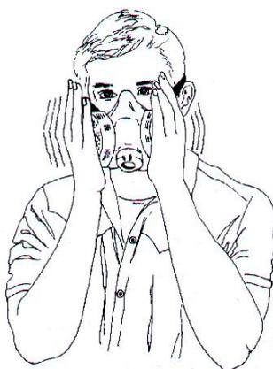
图 F.1 可更换式面罩负压气密性检查
