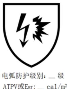
图1 防电弧服图形符号
